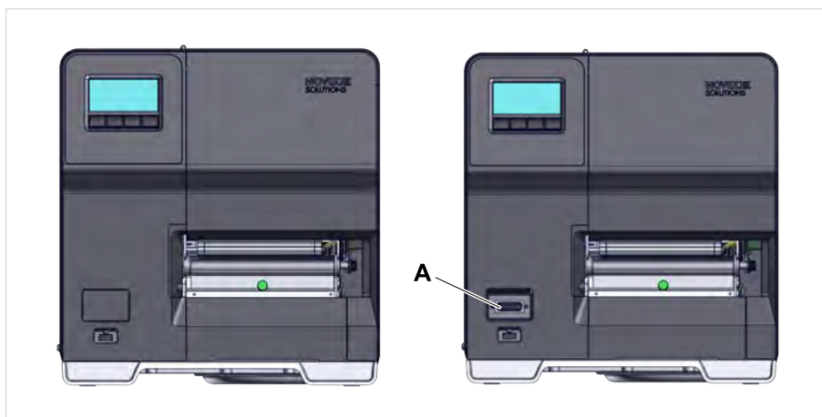
Figur 9: Uvendige forskelle: "Peripheral"-versionen (til højre) har en Sub-D tilslutning (A) på forsiden under betjeningsfeltet (gælder kun for printere i den pågældende version uden yderligere interne optioner ).
